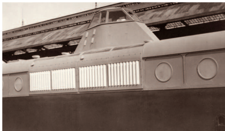
La vigie d'une rame triple dont la hauteur du toit a été rehaussée à 4,210 mètres au dessus du niveau des voies. Cela permet au conducteur de distinguer les voies à environ 100 mètres au-delà de l'avant de la rame. La visibilité est donc supérieure à celle d'une rame double. Pour les manœuvres en gare, le conducteur est cependant assisté par un agent installé dans le poste d'observation situé à chaque extrémité de la rame.
