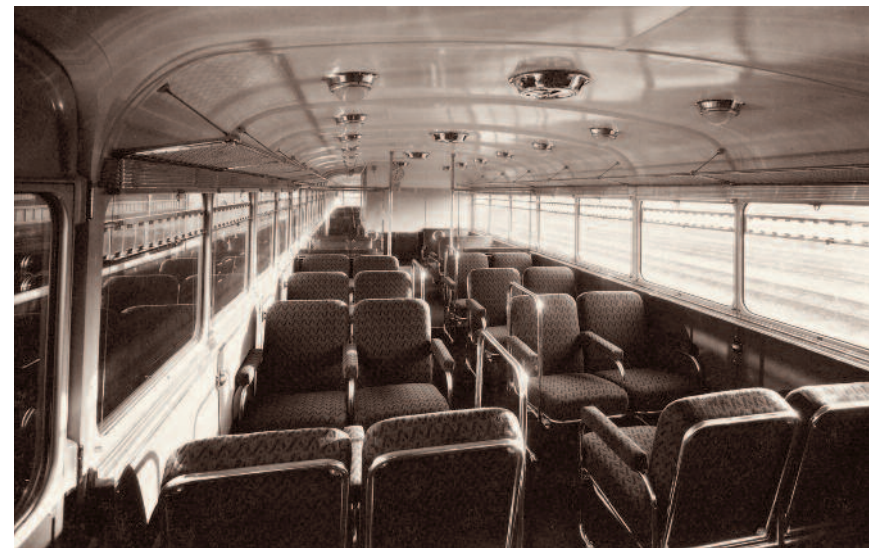
Une vue de l'intérieur d'un WLG "allongé" dont le nombre de places varie de 44 à 52 places, suivant la configuration. Noter la présence dans cet exemplaire de fauteuils (au premier plan) et de banquettes (devant le local moteur).
