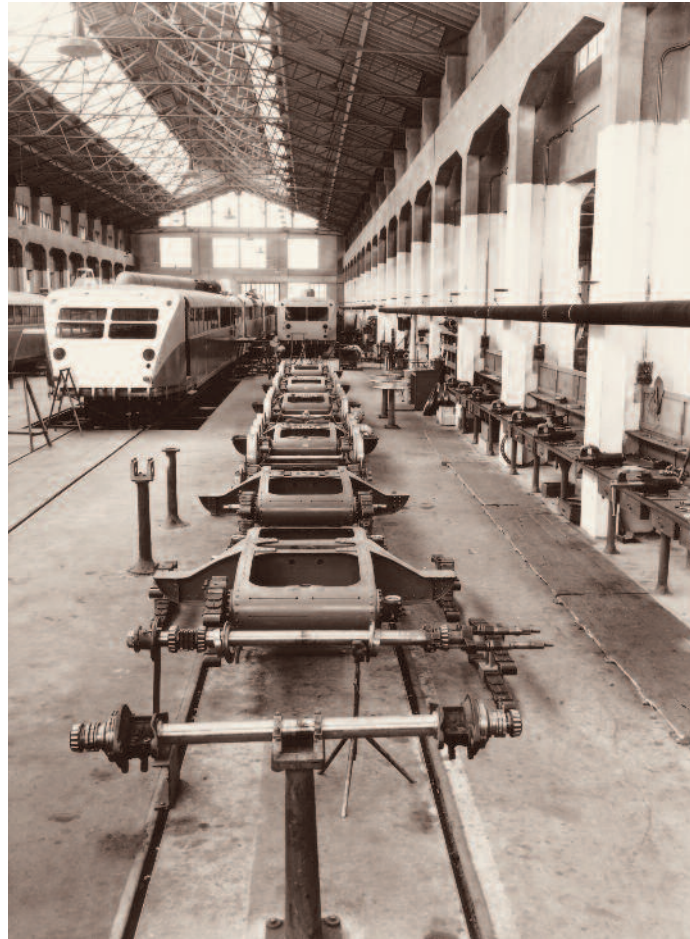
Plusieurs essieux et bogies en cours de montage dans le hall de l'usine.
